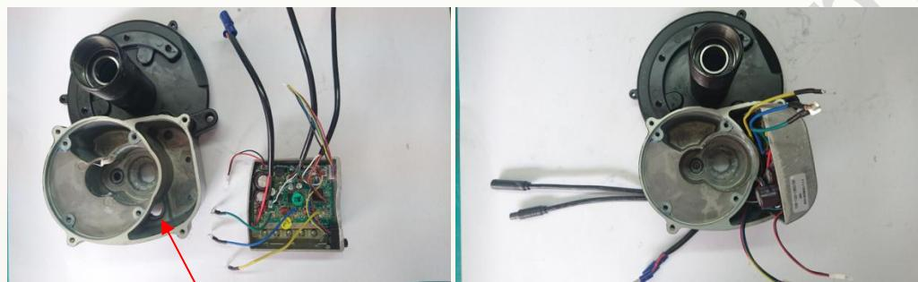
图示三根黑色线由此孔穿入 the three black wires entrance this hole
