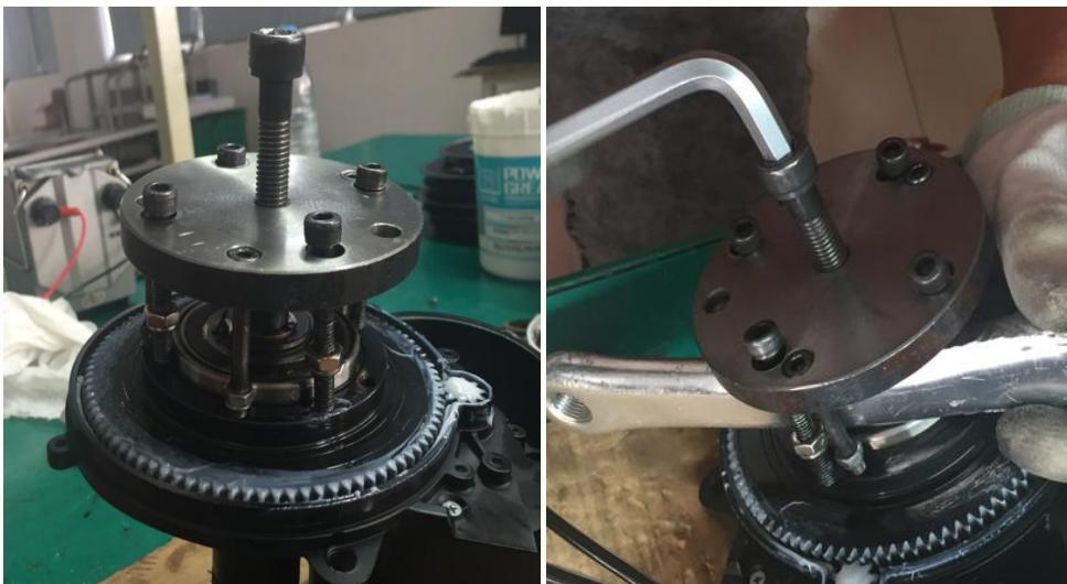
将拉码上 5 个螺钉固定在齿轮螺钉孔位，并使用内六角扳手顺时针旋转中间的螺钉，取下大齿轮。
